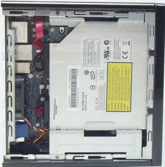
▲ 內部使用的零組件規格與筆記型電腦相同，因此體積才能這麼輕巧
