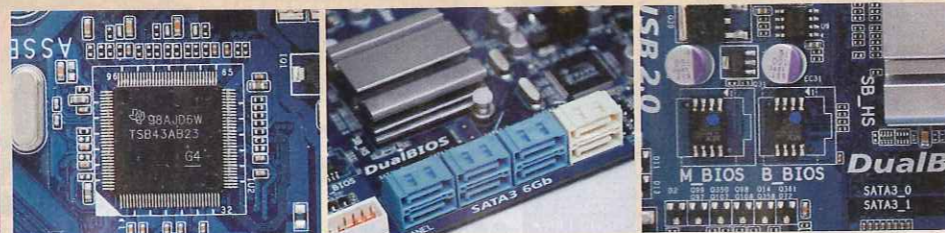
採用名廠TI TSB43AB23晶片，可支援多達8個內置SATA埠，為參賽8 Gigabyte的招牌Dual BIOS功能。提供多達3個IEEE1394a埠。強中最多。
